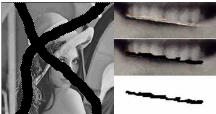
Obrázek 56: Označení poškozené části obrazu a) automaticky například vyplněním oblasti se stejnou intenzitou obrazových bodů b) ručně vytvořená maska.
