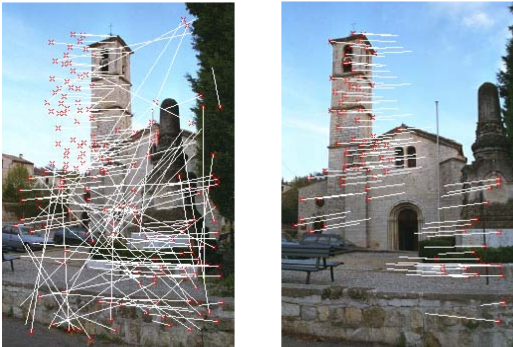
Obrázek 4.3.1: Obrázek demonstrující odstranění outlierů metodou RANSAC, odhadující model epipolární geometrie.
