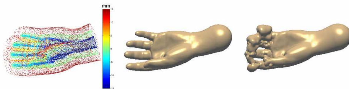
Obrázek 2.6.2.1.B: Vlevo: povrchové body získané laserovým scannerem jsou zobrazeny zeleně, červeně jsou pak nejvzdálenější vnější off-surface body, modře nejvzdálenější vnitřní off-surface body. Uprostřed: správné určení vzdáleností off-surface bodů. Vpravo: špatné určení vzdáleností off-surface bodů. [Carr01]
